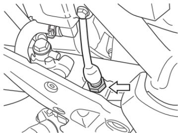
Um den Bremslichtschalter einzustellen, halten Sie das Schaltergehäuse und drehen Sie den Einsteller so, dass das Bremslicht bei Betätigung des Bremspedals kurz vor dem Druckpunkt aufleuchtet.
