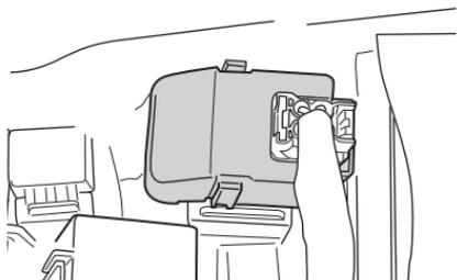
Die Hauptsicherung befindet sich unter dem Sitz. Um Zugang zur Sicherung zu erhalten, nehmen Sie den Sitz wie im Abschnitt SITZSCHLOSS beschrieben ab. Im Starterrelaiskasten befindet sich eine 30 A Reservesicherung.
