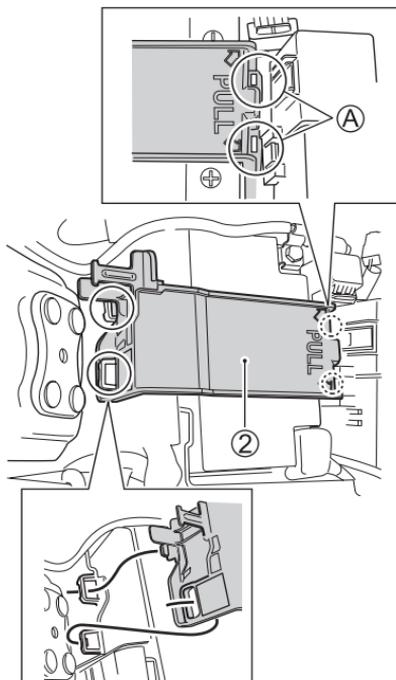
4. Ziehen Sie die Haken der Batteriehalterung A ab und entfernen Sie die Batteriehalterung ②.
