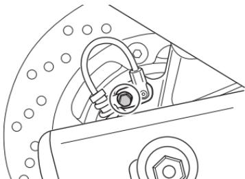
2. Nehmen Sie den Hinterraddrehzahlsensor nach Herausdrehen der Befestigungsschraube ab.
