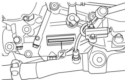
Die Seriennummer des Rahmens und/oder des Motors werden für die Anmeldung des Motorrads benötigt. Außerdem erleichtern sie Ihrem Händler die Bestellung von Teilen und das Auffinden spezieller Wartungsinformationen. Die Rahmennummer ① ist am Lenkkopfrohr eingestanz. Die Motornummer ② ist am Kurbelgehäuse eingestanz.
