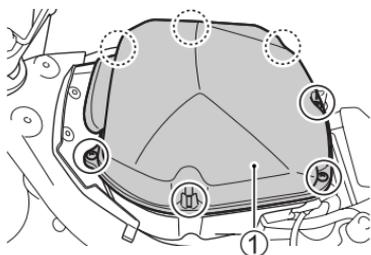
2. Entfernen Sie die sieben Schrauben.
