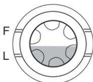
3. Halten Sie das Motorrad senkrecht und prüfen Sie den Motorölstand im Schauglas an der rechten Seite des Motors.
