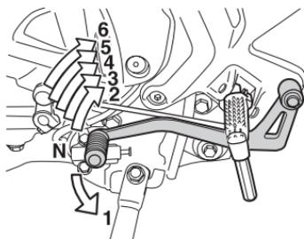
Dieses Motorrad ist mit einem 6-Gang-Getriebe ausgestattet, das wie dargestellt geschaltet wird. Zum Schalten ziehen Sie den Kupplungshebel und nehmen das Gas weg, während Sie gleichzeitig den Schalthebel betätigen. Zum Hochschalten ziehen Sie den Schalthebel nach oben, zum Herunterschalten drücken Sie ihn nach unten. Der Leerlauf liegt zwischen dem 1. und 2. Gang. Um in den Leerlauf zu schalten, drücken oder ziehen Sie den Hebel zwischen den 1. und 2. Gang.
