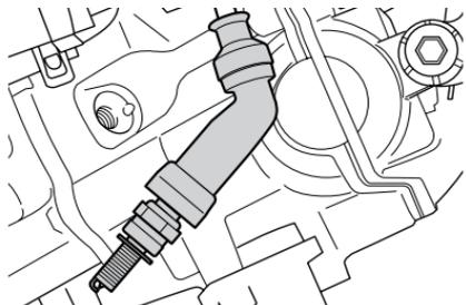
2. Während Sie die Zündkerze fest gegen das Kurbelgehäuse des Motors halten, drücken Sie den Starterknopf, wobei der Zündschalter in Stellung „ON“ (Ein), der Motorstoppschalter in Stellung „ $\Omega$ “, das Getriebe im Leerlauf und die Kupplung ausgerückt ist. Wenn die Zündanlage in Ordnung ist, muss ein blauer Funke zwischen den Elektroden überspringen.
