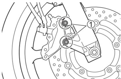
3. Nehmen Sie beide Bremssättel von den Teleskopgabelholmen ab, indem Sie die zwei Befestigungsschrauben (1) an jedem Bremssattel herausdrehen.
