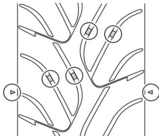
**ZUR BEACHTUNG:** Die Markierung „ $\Delta$ “ zeigt die Stelle an, wo die Verschleißindikatoren im Reifen eingelassen sind. Wenn der Verschleißindikator dieselbe Höhe besitzt wie die Reifenoberfläche, ist die Verschleißgrenze des Reifens erreicht.
