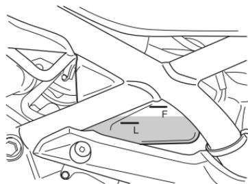
Der Kühlmittelstand im Ausgleichsbehälter soll sich stets zwischen den Pegellinien „F“ (VOLL) und „L“ (NIEDRIG) befinden. Kontrollieren Sie den Füllstand bei senkrecht stehendem Motorrad vor jeder Fahrt. Wenn der Kühlmittelstand die Pegellinie „L“ unterschreitet, füllen Sie vorgeschriebenes Motorkühlmittel wie folgt nach:
