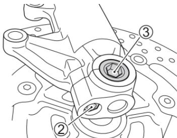
4. Lösen Sie die Achshalterschraube (2) am rechten Gabelholm.
