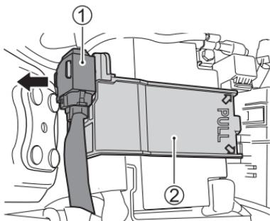
3. Nehmen Sie den Sensor der Benzinabschaltung ① von der Batteriehalter ② ab.
