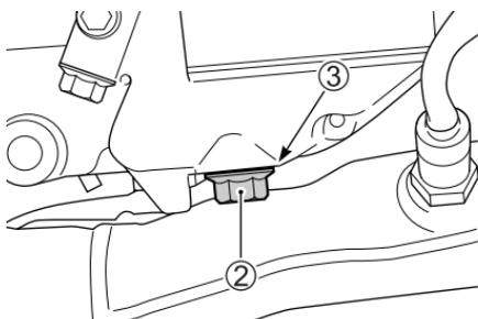
3. Nehmen Sie die Ablassschraube ② sowie die Dichtung ③ von der Unterseite des Motors ab, und lassen Sie das Motoröl in eine geeignete Wanne ablaufen.
