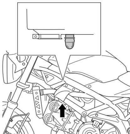
Bei der turnusgemäßen Wartung drehen Sie die Schraube heraus und lassen Wasser sowie Öl ab. Die Luftfiltereinsatz-Ablassschraube befindet sich unter dem Luftfiltergehäuse.
