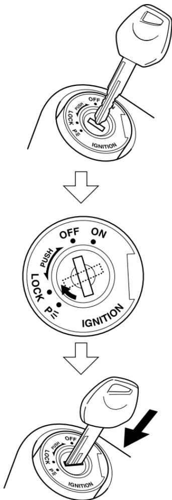
Beim Einstecken des Schlüssels drehen Sie die Abdeckung so, dass die Öffnung über der für den Schlüssel liegt.
