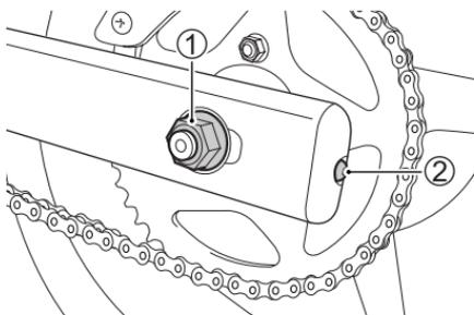
3. Schrauben Sie die Achsmutter ① ab.
