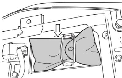
Ihr Motorrad wird mit einem Werkzeugsatz ausgeliefert. Er befindet sich unter dem Sitz.
