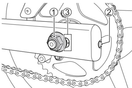
2. Lösen Sie die Achsmutter ①.
