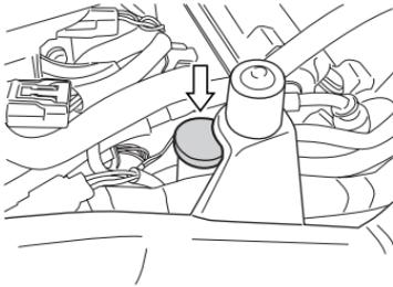
2. Nehmen Sie die Einfüllkappe ab und füllen Sie vorgeschriebenes Kühlmittel über die Einfüllöffnung nach, bis es die Linie „F“ erreicht. Siehe Abschnitt EMPFEHLUNGEN ZU KRAFTSTOFF, MOTORÖL UND KÜHLMITTEL.
