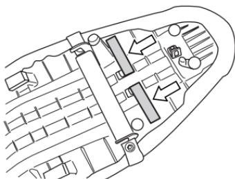
Die Gepäckschlaufen befinden sich gefaltet unter dem Sitz. Ziehen Sie die Schlaufen von den Haken, führen Sie sie nach außen und bringen Sie den Sitz wieder an. Gepäck auf dem Sitz kann mit Spanngurten oder Ähnlichem an den Schlaufen gesichert werden.
