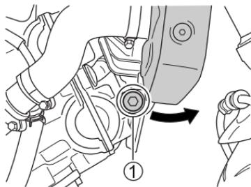
1. Drehen Sie die Schraube ① heraus. Ziehen Sie den unteren Teil des Kühlers nach vorn.
