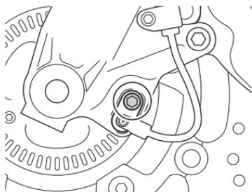
2. Nehmen Sie den Vorderraddrehzahlsensor nach Herausdrehen der Befestigungsschraube ab.
