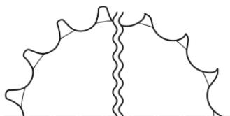
*ZUR BEACHTUNG: Vor Einbau einer neuen Antriebskette sollten die beiden Kettenräder auf Verschleiß geprüft und bei Bedarf ebenfalls ausgetauscht werden.*
