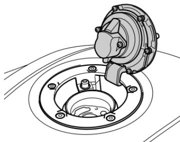
Zum Öffnen des Tankdeckels stecken Sie den Zündschlüssel in das Schloss und drehen Sie ihn im Uhrzeigersinn. Öffnen Sie den Tankdeckel mit dem Schlüssel. Zum Schließen drücken Sie den Tankdeckel mit dem im Deckelschloss steckenden Schlüssel fest nach unten.
