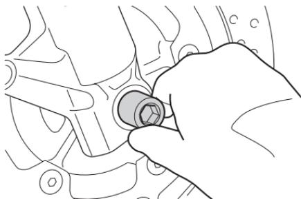
8. Drehen Sie die Achse entgegen dem Uhrzeigersinn und ziehen Sie sie heraus.
