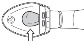
2. Drücken Sie die Lampe hinein, drehen Sie sie nach links, und ziehen Sie sie heraus.
