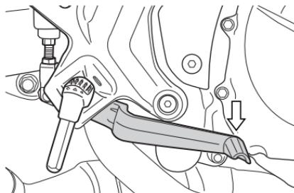
Durch Drücken des Hinterradbremspedals wird die Hinterradscheibenbremse betätigt. Bei Betätigung der Hinterradbremse leuchtet die Bremsleuchte.
