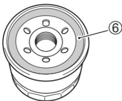
6. Verteilen Sie ein wenig Motoröl um die Gummidichtung ⑥ des neuen Ölfilters.
