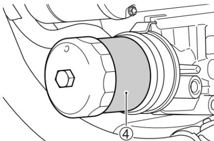
4. Drehen Sie den Ölfilter ④ entgegen dem Uhrzeigersinn und nehmen Sie ihn ab. Verwenden Sie hierzu einen Suzuki-Aufsetz-Ölfilterschlüssel oder einen Band-Filterschlüssel geeigneter Größe.
