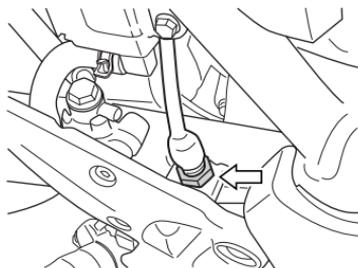
Um den Bremslichtschalter einzustellen, halten Sie das Schaltergehäuse fest und drehen Sie den Einsteller so, dass die Bremsleuchte bei Betätigung des Bremspedals kurz vor dem Druckpunkt aufleuchtet.
