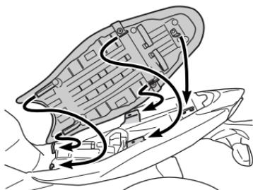
Zum Entriegeln des Sitzschlosses stecken Sie den Zündschlüssel in das Schloss und drehen Sie ihn im Uhrzeigersinn. Zum Verriegeln des Sitzes schieben Sie die Sitzhaken in die Sitzhakenhalter und drücken Sie den Sitz fest nach unten, bis der Sitz einrastet.
