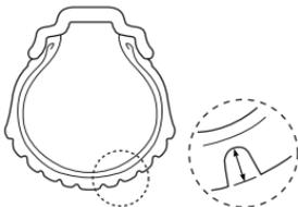
Kontrollieren Sie den Zustand der Reifen vor jeder Fahrt. Wenn ein Reifen sichtbare Anzeichen einer Beschädigung aufweist, wie z. B. Risse oder Einschnitte, oder wenn die Profiltiefe beim Vorderreifen 1,6 mm und beim Hinterreifen 2,0 mm unterschreitet, ist der Reifen auszuwechseln.
